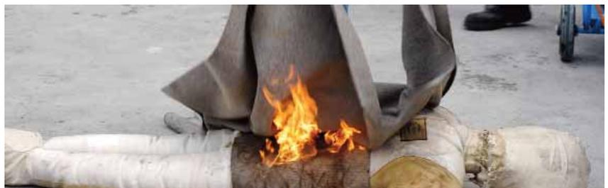
Die Bilder oberhalb zeigen den Einsatz eines Handfeuerlöschers sowie einer Löschdecke im Zuge einer Brandschutzübung.
